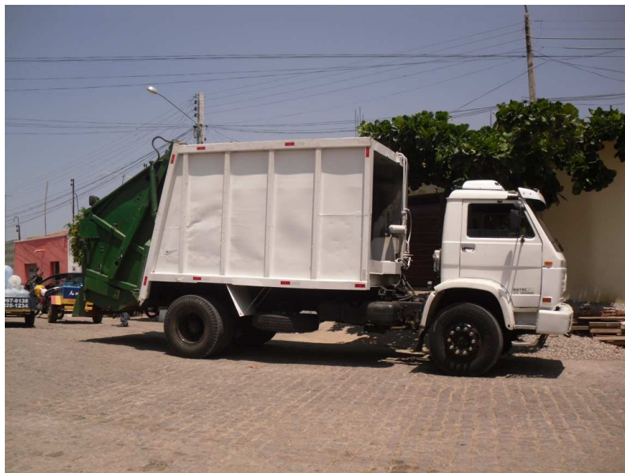
Figura 3 – Caminhão Compactador utilizado na coleta.
